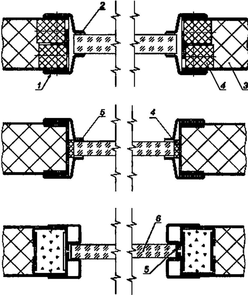
1) — стеклодержатель. 2 — уплотнитель. 3, 4 — негорючие теплоизоляционные материалы.
