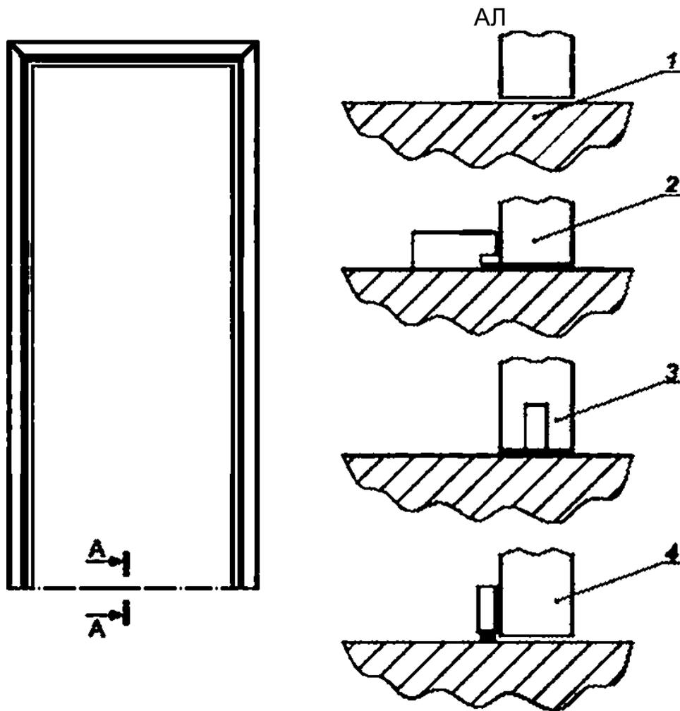
1 — без порога; 2 — с приставным порогом. 3 — с выдвигным порогом встроенного типа.
